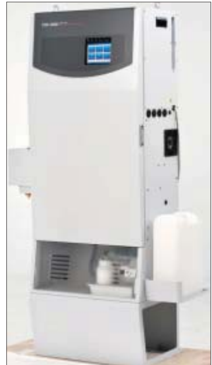
Фото № 4. Автоматический 6-канальный ТОС-анализатор SHIMADZU модели ТОС-4200
