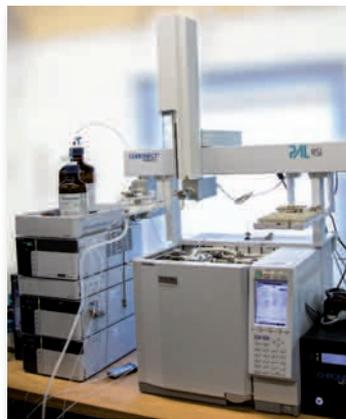
Рисунок 4: Хроматографическая MOSH/MOAN система
