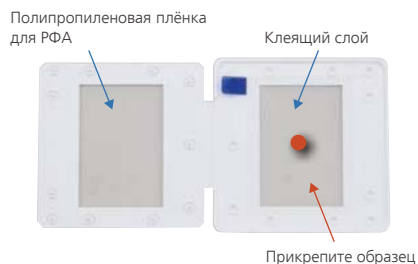
Держатель в открытом состоянии (внутренняя часть)
