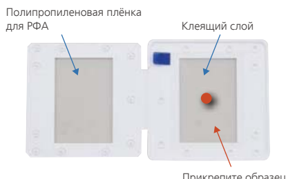
Держатель в открытом состоянии (внутренняя часть)
