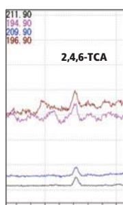
1 ppt трихлоранизола в вине (стандартный режим)
