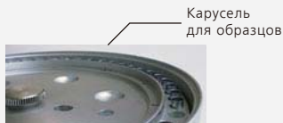
Пиролизер устанавливается внутри автоматического пробоотборника
