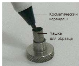
Размещение образца грифеля в чашке для проб
