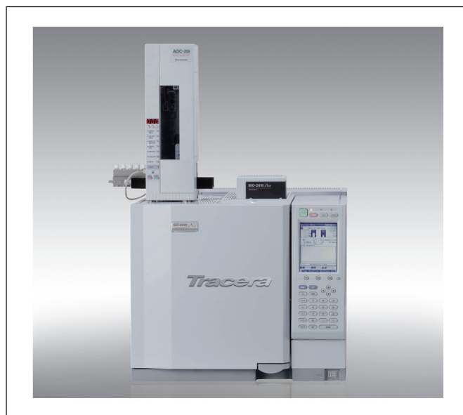
Рис.2. Система TracerA – комбинация газового хроматографа GC-2010 Plus и нового ионизационного детектора барьерного разряда BID-2010 Plus
